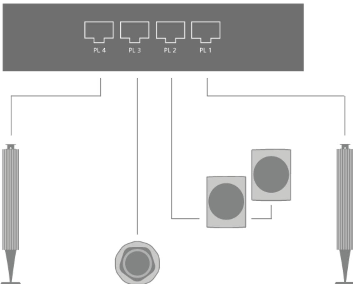
In der Abbildung wird ein Beispiel für die Aufstellung mit zwei Lautsprechern vorne, zwei Lautsprechern hinten mit Daisy-Chain-Verbindung und einem Subwoofer dargestellt.
