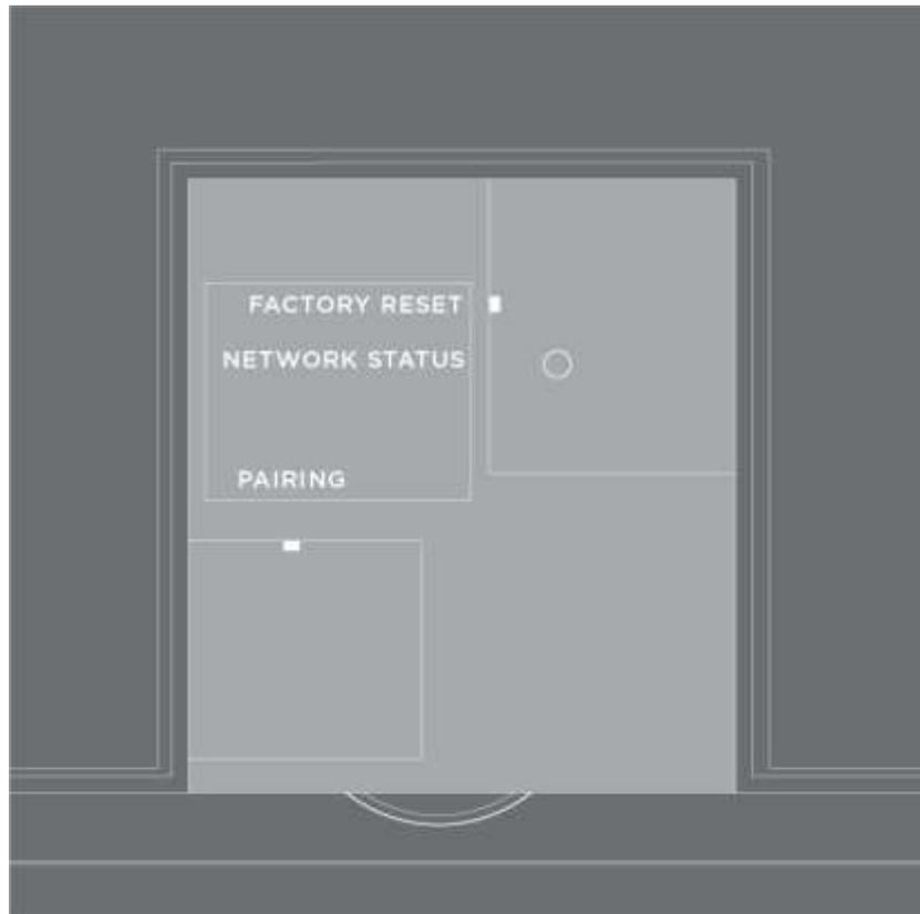
Wenn Sie die Taste PAIRING (KOPPLUNG) unten auf der Rückseite der rechten Lautsprecherbox 1,5 Sekunden lang gedrückt halten, aktivieren Sie die Kopplung des Geräts mit einer Fernbedienung. Um den Kopplungsmodus zu beenden, müssen Sie lediglich erneut die Taste drücken.
